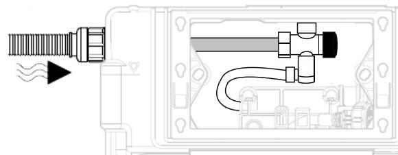
**SE** Kallvattensanslutining sker mot utvärdig gänga R15 (1/2") enligt rör- och kopplingstillverkarens monteringsanvisning.
